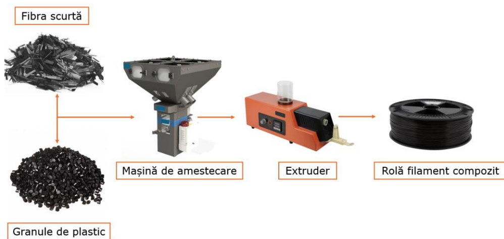
Fig. 2. Procesarea filamentului FDM cu fibre scurte prin amestecare și extrudare
